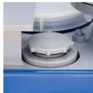
②ポンプサクシヨ口 ここより液を吸い出します。このサクシヨ口からタンク底20ミリのところまでは内部配管が下がっています。
