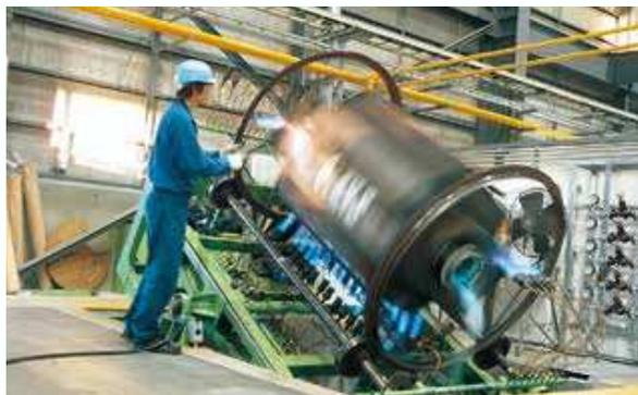
スイコーの大型容器はオランダ・バッセンシューメーカー社が開発した回転成形技術(エンゲルプロセス)を用いて生産されています。
