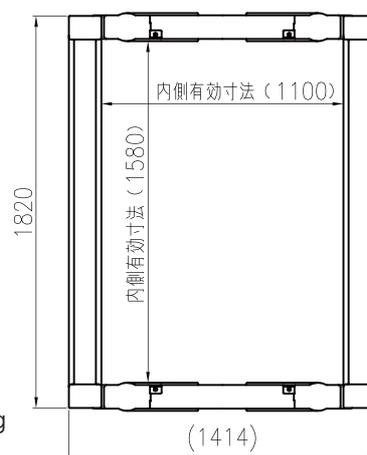
サイズ 1頭用 外寸幅 1414mm × 奥行 1820mm × 高さ 1130mm 参考重量 約 60kg
