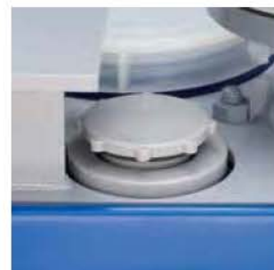
● ポンプサクション口 ここより液を吸引し出します。このサクション口からタンク底20 ミリのところまでは内部配管が下がっています。
