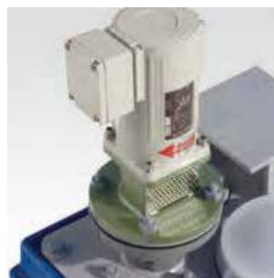
③攪拌機&攪拌架台 攪拌架台に攪拌機をボルト止めします。架台のフランジは規格品なので、お手持ちの汎用攪拌機もご使用頂けます。
